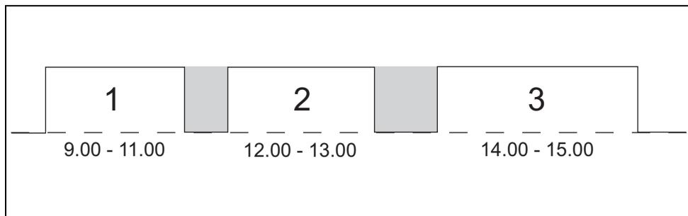
*Die Maschine schaltet um 9.00/12.00/14.00 automatisch ein. Die Maschine ist um 11.00/13.00/15.00 auf Standby. Während des Standby-Modus ist das Bedienfeld ausgeschaltet und die Boilertemperatur fällt auf die eingestellte Boilertemperatur ab.*
