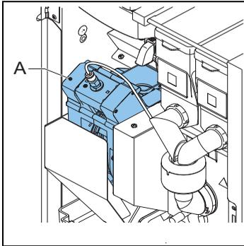
Der Brüher (A) erhält das Produkt vom Mahlwerk. Das Produkt wird nach Hinzufügen von heißem Wasser unter Druck zubereitet. Der Brüher leitet das Produkt an den Auslass und den Reststoff an den Abfallbehälter.
