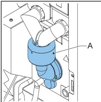
Der Mixer (A) mischt die Instant-Produkte mit heißem Wasser und leitet das Produkt an den Auslass.
