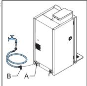
3 Verbinden Sie die Maschine (A) gegebenenfalls mit dem Schlauch (B) mit dem Filtersystem (C) und verbinden Sie das Filtersystem mit dem Schlauch (D) mit einem Hahn.
