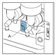
Mit dem Ein-/Aus-Schalter (A) wird die Maschine ein- und ausgeschaltet. Die Maschine kann immer noch aufgeladen sein, nachdem sie ausgeschaltet wurde. Ziehen Sie den Stecker der Maschine aus der Steckdose, um sicherzustellen, dass sie vollkommen entladen ist.
