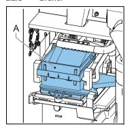
Der Brüher (A) erhält das Produkt vom Mahlwerk. Das Produkt wird erzeugt, indem heißes Wasser durch den Filter gesaugt wird. Der Brühkolben überträgt das Produkt auf den Auslass. Ein Wischer überträgt die Reste in den Abfallbehälter.
