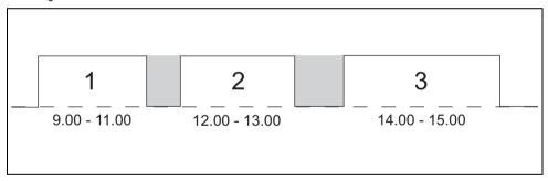
Die Maschine schaltet um 9.00/12.00/14.00 automatisch ein. Die Maschine ist 11.00/13.00/15.00 auf Standby. Während des Standby-Modus ist das Bedienfeld ausgeschaltet und die Boilertemperatur fällt auf die eingestellte Boilertemperatur ab.
