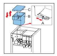
5 Reinigen Sie das Mahlwerk (A) mit der Bürste.
