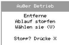
3. Halten Sie den Prozess an, Drücke x. Der Boiler ist jetzt ohne Druck.
