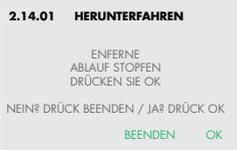
3. Jetzt ist der Boiler drucklos. Das Menü zum Herunterfahren kann, sofern erforderlich, beendet werden. Folgen Sie dem Menü, um das komplette Wassersystem zu entleeren.
