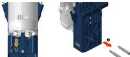
Stifte zu entfernen. Entferne zuerst die C-Clips womit die Stifte am Hauptrahmen befestigt sind.
