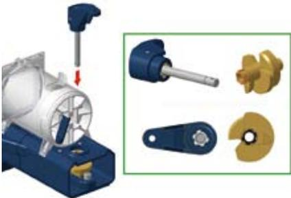
12. Stelle, wenn Sie sicher sind, dass die Kurbel- und Dreifach-Nockenwelle richtig ausgerichtet ist, einen Körner in die Mitte der Kurbelwelle und klopfe ein oder zwei mahl mit dem Hammer. Wenn die beiden richtig ausgerichtet sind, wird sich die Kurbelwelle leicht mit der Dreifach-Nockenwelle verbinden.
