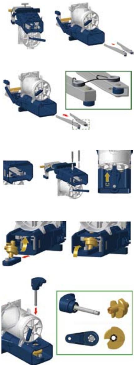
12. En premier, s'assurer que l'axe et la triple cam soient correctement alignés, les centrer ( avec la manivelle sur le coté), et donner un ou deux coups. Si les deux sont bien alignés, l'axe entrera facilement dans la triple cam.
