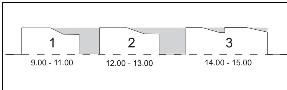
Si la machine est mise en marche après une pause mais sans distribution, elle passe en mode d'économie d'énergie après 30 min. La température de la chaudière chute toutes les 30 min. de 5 °C. En cas de distribution après 2 heures, la machine se réactive. La machine consomme moins d'énergie en l'absence de distribution ou de mise sous tension.
