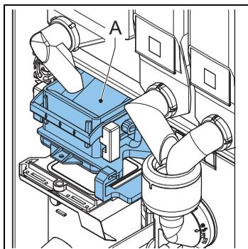
Le percolateur (A) reçoit le produit du conteneur. Le produit est préparé par aspiration de l'eau chaude dans le filtre. Le piston de percolateur transfère le produit dans la sortie. Un essuyeur transfère le résidu dans la poubelle.
