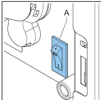
L'interrupteur marche /arrêt (A) met la machine en marche /arrêt. La machine peut encore être sous tension même si elle est arrêtée. Débranchez la machine pour vous assurer qu'elle n'est plus du tout sous tension.
