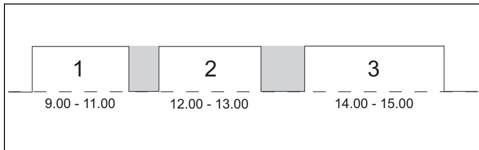
La machine se met en marche automatiquement à 9h00/12h00/14h00. La machine est en pause à 11h00/13h00/15h00. En pause, le panneau de commande est éteint et la température de la chaudière chute à sa température de réglage.
