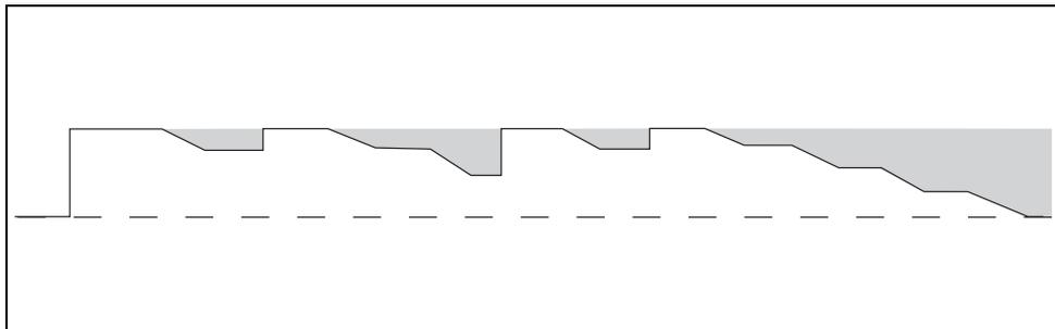
*Si la machine est mise en marche mais sans distribution, elle passe en mode d'économie d'énergie après 30 min. La température de la chaudière chute toutes les 30 min. de 5 °C. En cas de distribution après 2 heures, la machine se réactive. La machine consomme moins d'énergie en l'absence de distribution ou de mise sous tension.*
