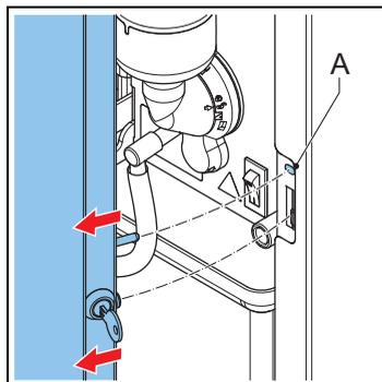
L'interrupteur de porte (A) met automatiquement la machine hors tension dès l'ouverture de la porte.
