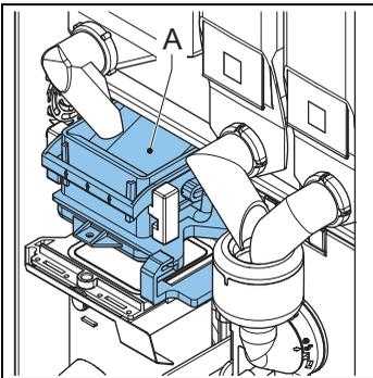
Der Brüher (A) erhält das Produkt vom Kanister. Das Produkt wird durch Vakuumisieren von heißem Wasser durch den Filter zubereitet. Der Brüherkolben überträgt das Produkt zum Auslass. Ein Wischer überträgt den Rückstand zum Abfallbehälter.
