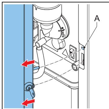
Der Türschalter (A) schaltet die Maschine automatisch aus, wenn die Tür geöffnet wird.
