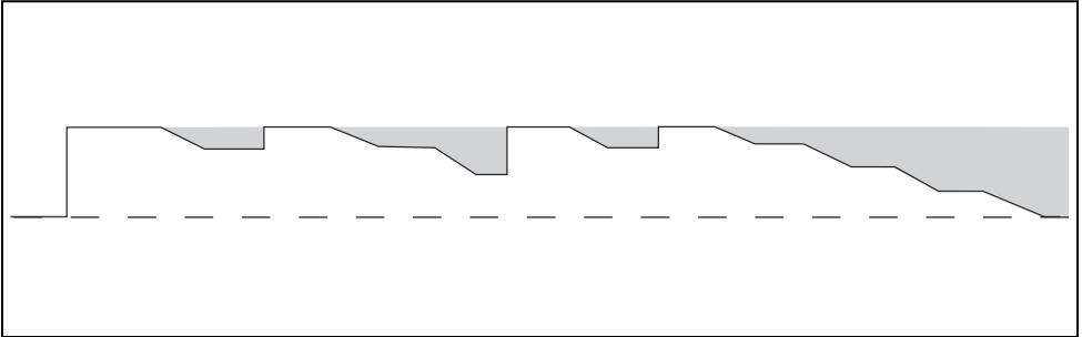
*Wird die Maschine eingeschaltet und kein Spendevorgang findet statt, schaltet sie nach 30 Minuten in den Energiesparmodus. Die Temperatur des Boilers fällt alle 30 Minuten um 5 °C ab. Findet nach 2 Stunden ein Spendevorgang statt, wird die Maschine reaktiviert. Die Maschine verbraucht weniger Energie, wenn kein Spendevorgang stattfindet oder sie eingeschaltet bleibt.*
