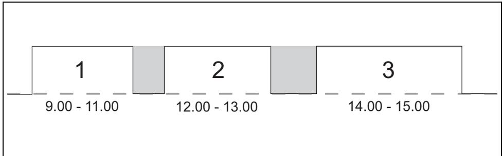
Die Maschine schaltet um 9.00/12.00/14.00 automatisch ein. Die Maschine ist 11.00/13.00/15.00 auf Standby. Während des Standby-Modus ist das Bedienfeld ausgeschaltet und die Boilertemperatur fällt auf die eingestellte Boilertemperatur ab.
