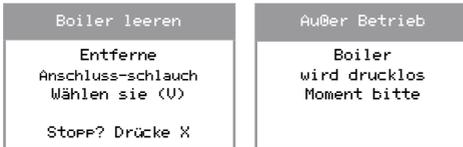
3. Der Boiler ist jetzt ohne Druck. Das Ausserbetriebnahmemenü kann eventuell abgebrochen werden. Folgen Sie dem Menü, um das komplette Wassersystem zu leeren.
